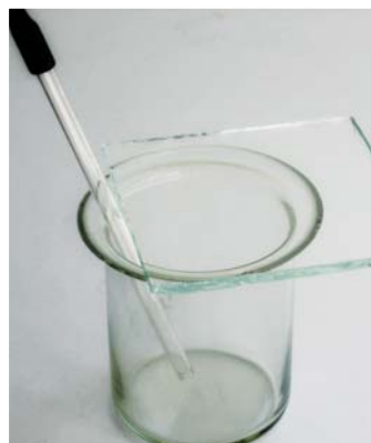
Мал. 6. Збирання газу, який утворюється під час реакції
