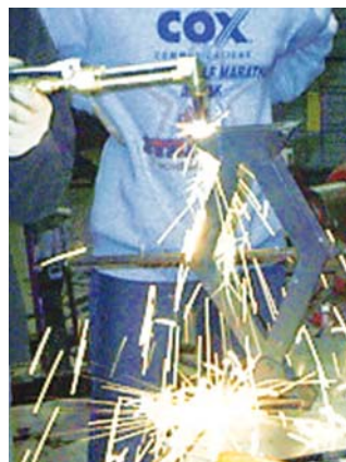
Мал. 108. Різання металу за допомогою ацетиленового пальника
