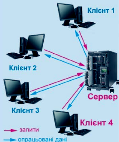
Мал. 6.2. Схема використання бази даних за клієнт-серверною технологією
