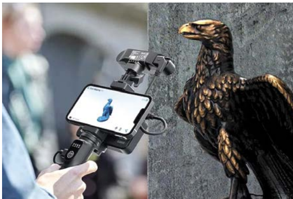
Мал. 4.8. Побудова 3D-моделі скульптури з використанням 3D-сканера
