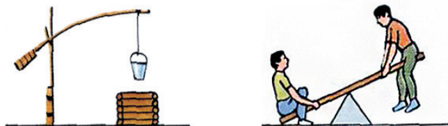
Демонстрація роботи простого механізму — важеля
