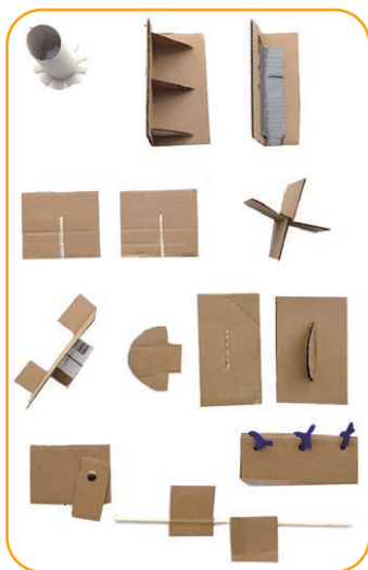
Методи кріплення деталей з картону
