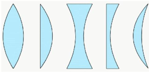
Відбиття та заломлення світла використовують в оптичних приладах та пристроях, у яких є спільний елемент – лінза. Лінзи виготовляють із прозорих матеріалів. Вони мають з обох боків поверхні, що нагадують частини поверхні кулі.
